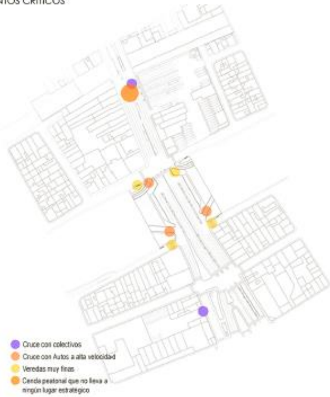
Los cruces por senda peatonal, que se producen entre estación de tren y las paradas de colectivos en frente, no tienen lugar para que la gran masa de personas espere cambio de semáforo.
